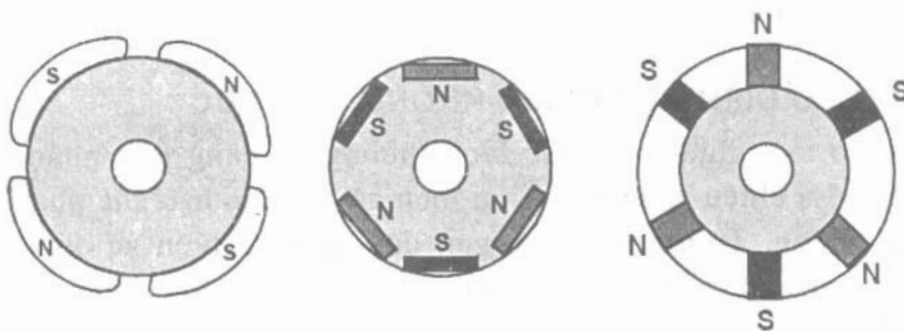
Hình 6.8. Mặt cắt ngang của một số dạng rôto
